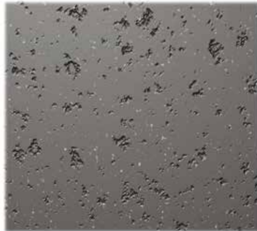
Gros plan des orifices produits par le revêtement APS des chemises des cylindres.
